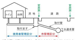
※取付管に故障が生じると、取付ますの中に汚水がたまります。 (この場合は、市が修理します)
