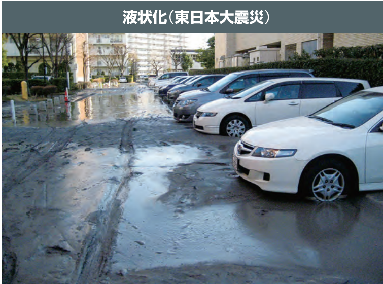
液状化(東日本大震災) 提供元:千葉県浦安市富岡エステート住宅管理組合自主防災隊 出典:地震本部ウェブサイト https://www.jishin.go.jp/
