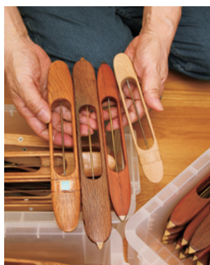
▲経糸の間を左右からくぐらせて緯糸を通す道具「杼」 たていと 。織物によって使い分ける。
