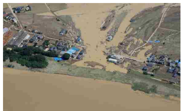
堤防決壊による家屋の流失(鬼怒川)
