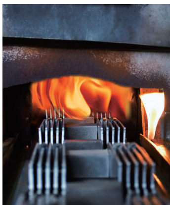
炉の癖を見極め刃物の量やセットする位置を変えていく
