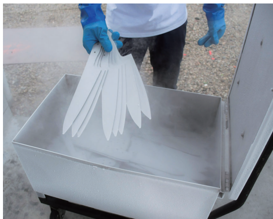
液体窒素を使い約マイナス110度でスーパーサブゼロ処理※1を行う
