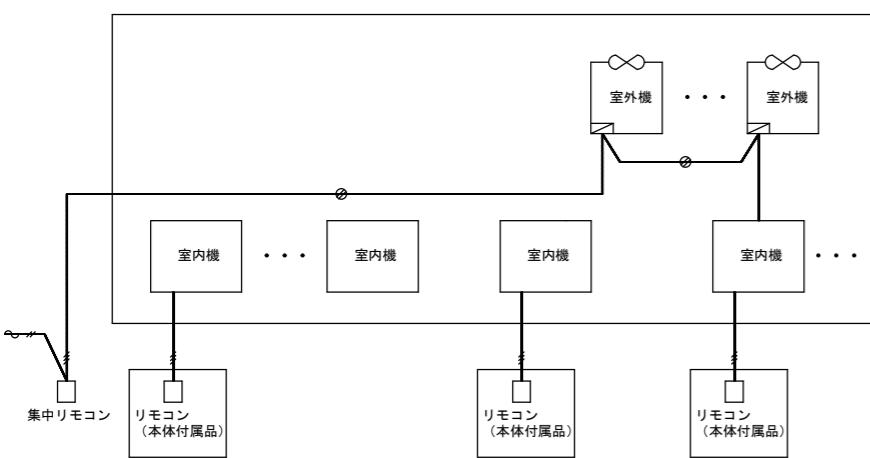
※リモコン及びリモコン配線工事は冷媒工事とする。
