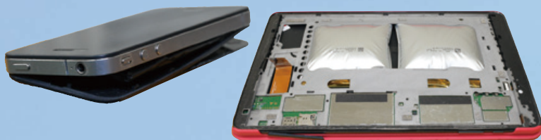
▲実際に膨らんだリチウムイオン電池
