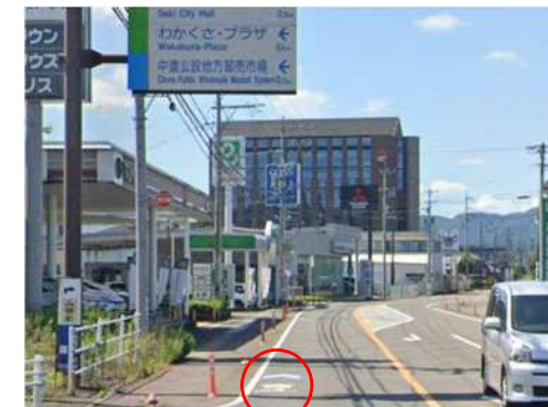
県道 関美濃線の矢羽根型路面表示
